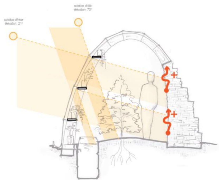
Image 10. Coupe illustrant le rôle de la masse thermique et le double rôle des étagères qui soutiennent les plantes et fournissent l'ombre en été.
