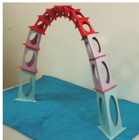
Images 8 et 9. Principe constructif de l'arche caténaire et géométrie de la structure en contreplaqué évidé.
